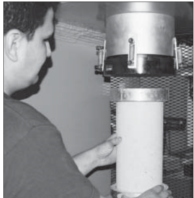
Ensayo de Concreto de Alta Resistencia
