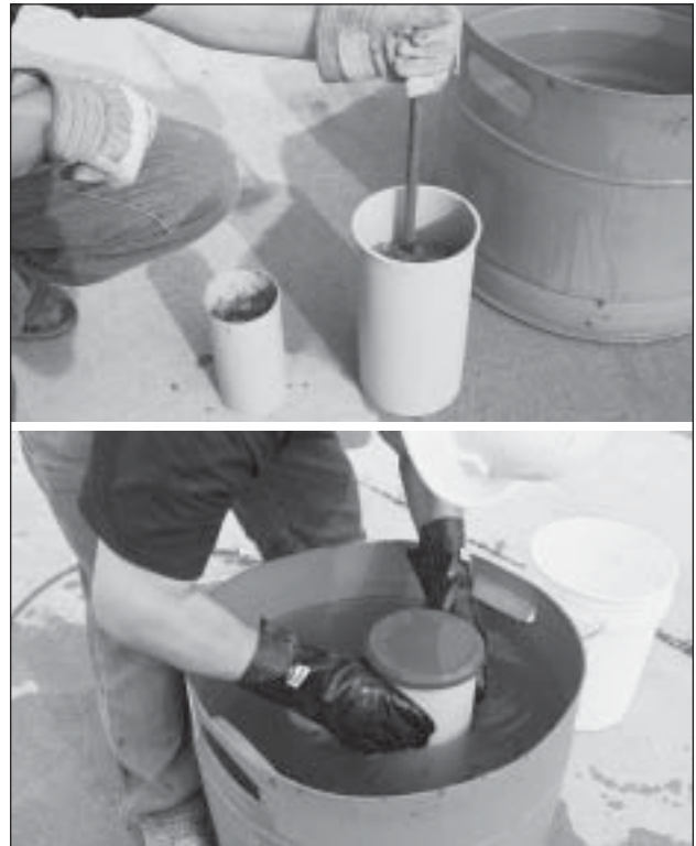
Preparación y Curado de Cilindros de Concreto en Campo
